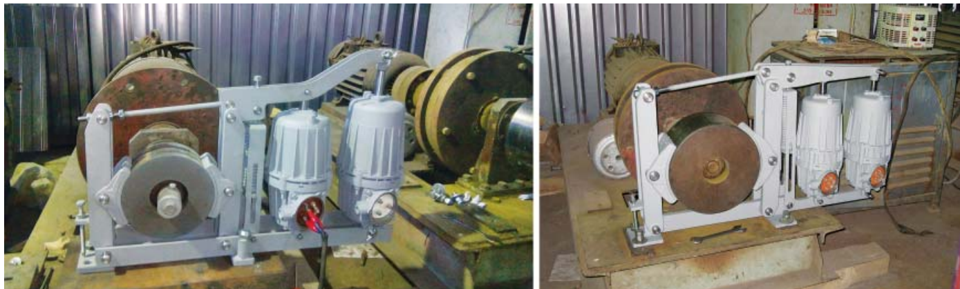
Рис. 3. Тормоза с дублированным приводом на инерционных испытательных стендах: а – ТКГ-200-50/30; б – ТКГ-300-80/50
