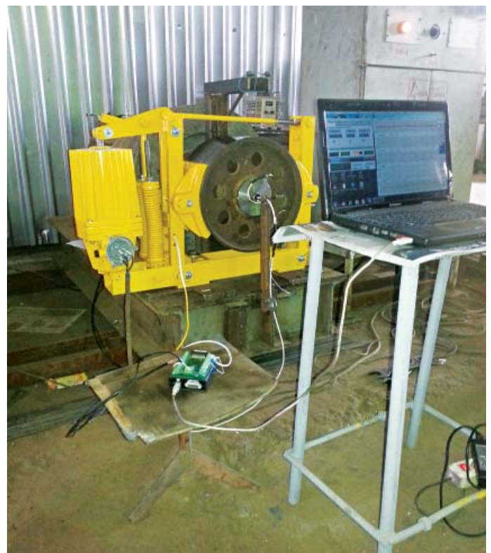
Рис. 2. Вид стенда с тормозом во время испытаний
