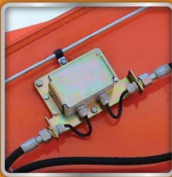
Датчик угла наклона
