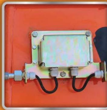
Датчик угла наклона
