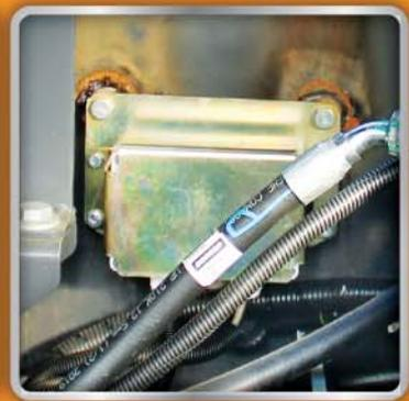
Датчик угла наклона
