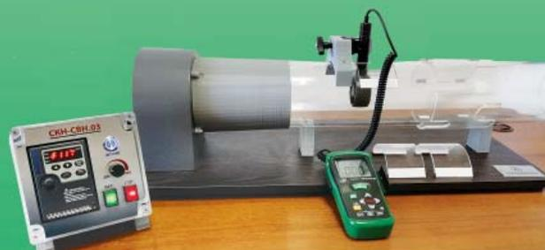
Стенд для проверки анемометров SKH-CBH.03
