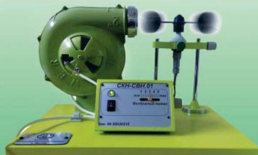
Стенд контроля и наладки сигнализаторов ветровой нагрузки SKH-CBH.01
