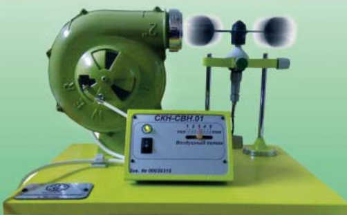
Стенд контроля и наладки сигнализаторов ветровой нагрузки СКН-СВН.01
