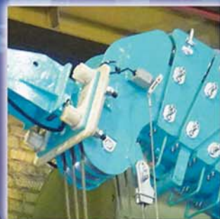
изоляция люльки для работы до 1000 В
