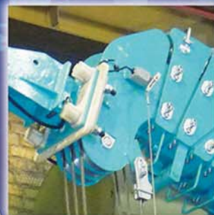
изоляция люльки для работы до 1000 В
