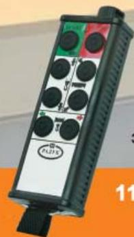
Кнопочные пульты применяются для радиуправления кран-балками или мостовыми (козловыми) кранами, имеющими одно- или двухскоростные электроприводы механизмов.
